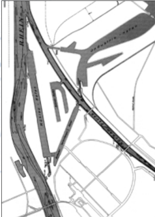
Ausbau des Handelshafens mit zwei zusätzlichen Becken und der neu angelegte Industriebahnhof (Karte aus dem Jahr 1914)
